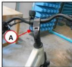
Figura 1 - Tornillo de fijación de la dirección del manillar.
