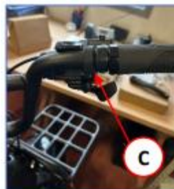
Figura 3 - Ajuste de la altura del manillar.
