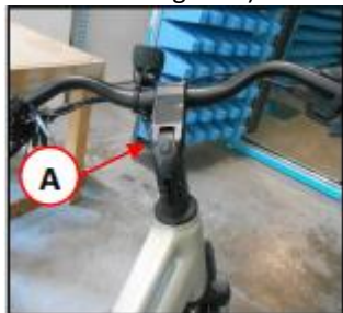
Figura 1 - Tornillo de fijación de la potencia del manillar.
