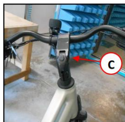
Figura 2 - Tornillos de fijación de la rotación longitudinal del manillar
